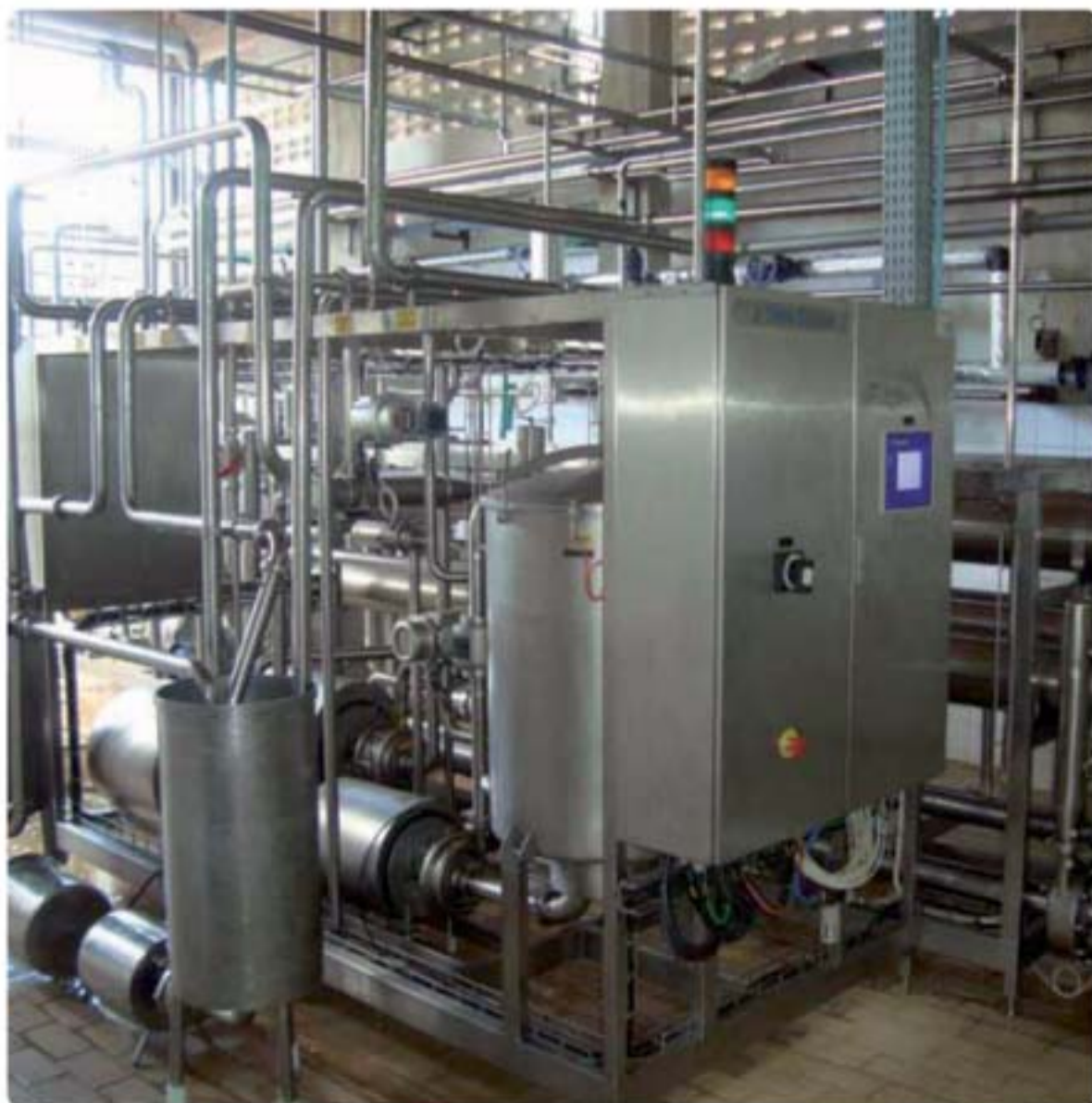
A máquina de osmose reversa produz o retentado, usado em indústrias alimentícias e farmacêuticas
